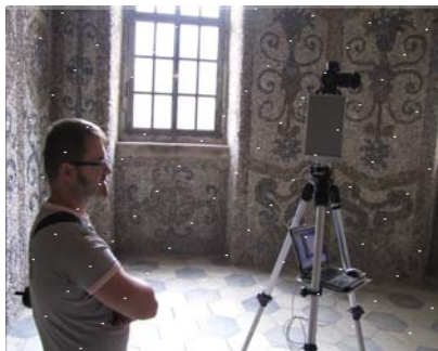
Provedení laserscanningu stavby fázovým laserovým skenerem (Geodis Brno, s.r.o.)
