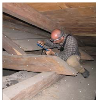
Odběr vzorků pro dendrochronologickou expertizu v krovu Rotundy
