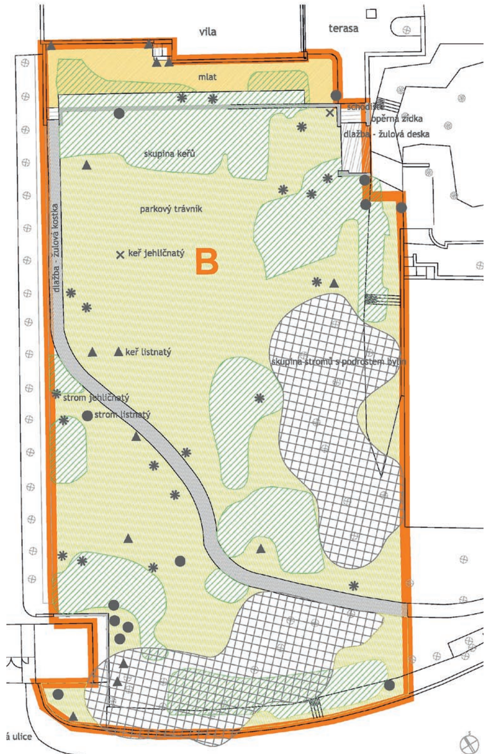
Obr. 38: Pasport části modelového objektu (tzv. Jižní parter zahrady vily Stiasní v Brně). Srovnáním s obr. 37 je zřejmé upřesnění polohopisu geodetického zaměření skupin keřů s ohledem na jejich detailní klasifikaci. Použité značky a výplně plošných prvků (šrafy, barva) nejsou standardizovány a jsou autorským řešením – v reálné dokumentaci jsou určeny legendou prvků. (FLORART, 2014)
