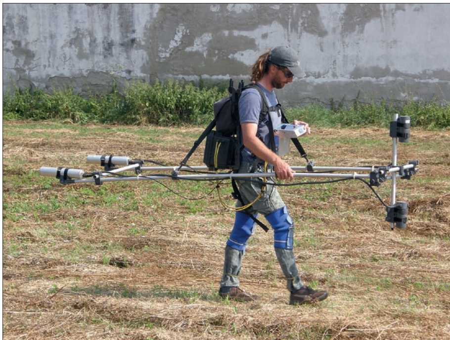
Obr. 20: Magnetometrické měření o kroměřížské Květné zahradě. (Foto J. Janál)
