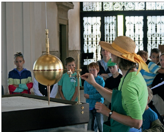
Obr. 52: Jednou z atraktivit Rotundy v Kojetné zahradě v Kroměříži je Foucaultovo kyvadlo, které dokazuje otáčení se Země kolem své osy. (Foto P. Hudec)
