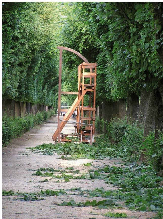
Obr. 6: Příklad plošiny s připojenou šablonou, která je používána na tvarování stěn ve vídeňském Schönbrunnu. (Foto L. Křesadlová, 2005)
