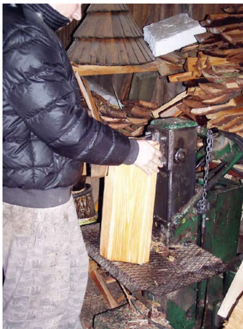
Čtorecní špalku na štípačce. (Foto V. Kolmačka)
