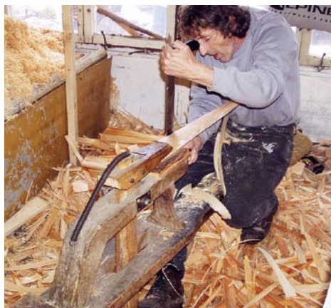
Úprava hrany šindele. (Foto V. Kolmačka)
