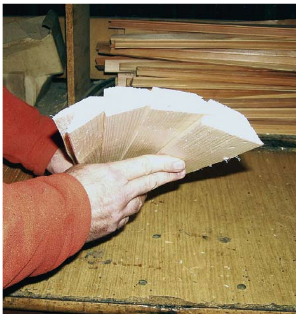
Typ šindele kosák jednostranný – polotovár. (Foto V. Kolmačka)
