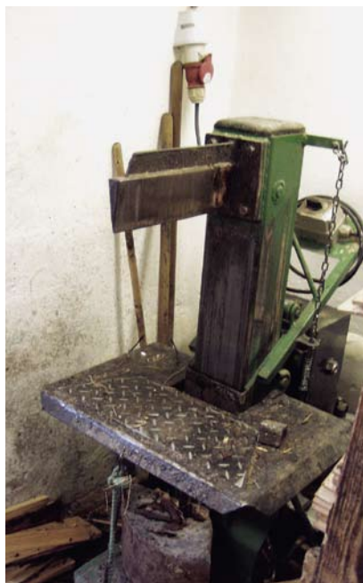
Štípačka – stroj na rozštípnutí kmene. (Foto V. Kolmačka)
