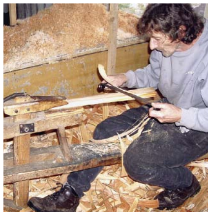
Strouhání šindele. (Foto V. Kolmačka)
