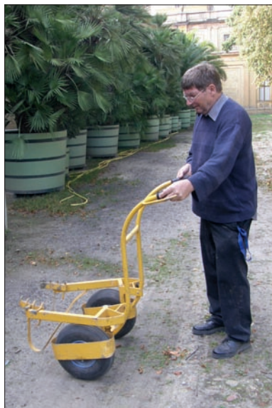
Obr. 10: Dooukoloový ruční vozík speciálně upravený pro transport rostlin v nádobách – Sanssouci. (Foto L. Křesadlová, 2009)
