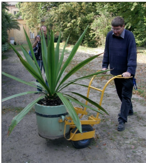
Obr. 10: Dooukoloový ruční vozík speciálně upravený pro transport rostlin v nádobách – Sanssouci. (Foto L. Křesadlová, 2009)
